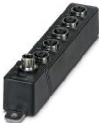
Switch Ethernet, 5 ports Ethernet en face avant au format M12, reconnaissance automatique du débit de transmission de données à 10 ou 100 Mbit/s, couplage de segments de réseau ayant des débits binaires différents, fonction auto-crossing (croisement automatique), indice de protection IP67
