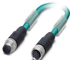
Câble préconfectionné pour bus, 8-pôles, connecteur mâle droit M12, détrompage: A, sur Connecteur femelle droit M12, détrompage: A, longueur de câble: 15 m
