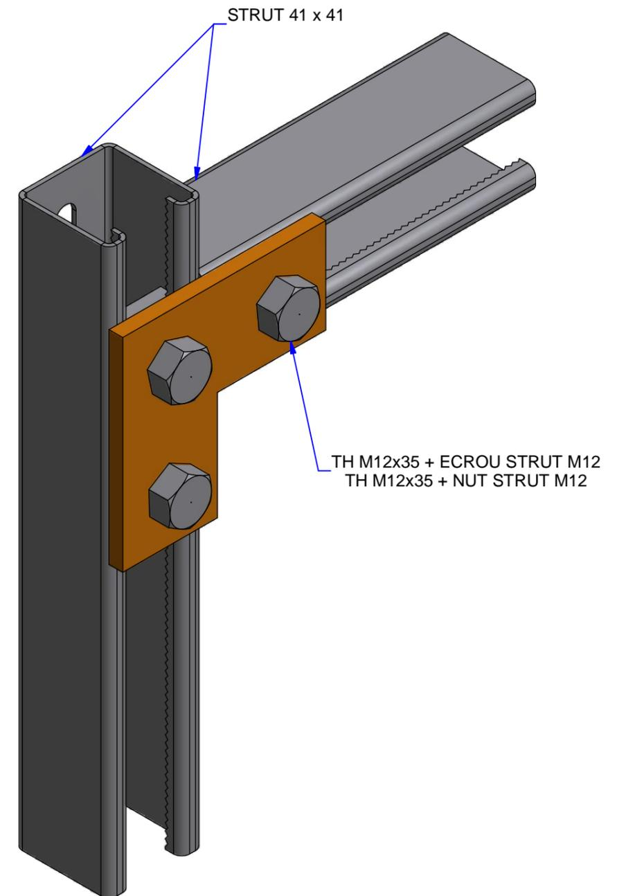
**GC** : Tôle d'acier galvanisé à chaud après fabrication suivant NF EN ISO 1461
