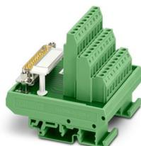
Module de transmission, raccordement 1: Connecteur mâle D-SUB 1x 25-pôles, raccordement 2: Raccordement vissé 27-pôles
