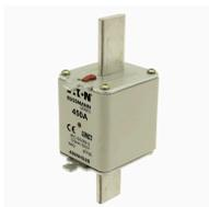
**Cartouche fusible, 450 A, AC 500 V, 120 kA, NH2, gL/gG, IEC, à double indicateur de fusion, pattes d'extraction conductrices**
