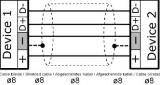
Cable blindé / Shielded cable / Abgeschirmtes Kabel / Abgeschermde Kabel / Cable blindado
