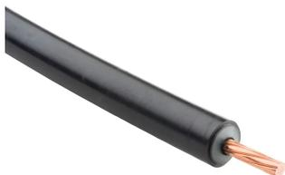
Le conducteur de descente isolé ISONV est un câble de descente, spécialisé dans la protection contre la foudre, qui peut être soumis pendant le fonctionnement à des courants de choc pouvant atteindre 200-kA. L'ISONV a été conçu et testé pour contrôler la distance de séparation et l'arc. Une couche extérieure semi-conductrice sert à limiter au maximum les gradients de potentiel en cas de foudre.
