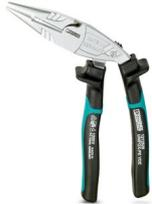
Pince droite, forme coudée, avec ressort d'ouverture et butée, poignée légèrement crantée, possibilité de dénudage pour 1,5 mm<sup>2</sup> et 2,5 mm<sup>2</sup>, clé polygonale intégrée M8 - M10, conforme à la norme VDE 1000 V AC/1 500 V DC, type de conditionnement : avec support pour présentoir (Backcard)
