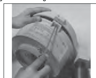
Figure 8 - Montage du boîtier sur le socle
