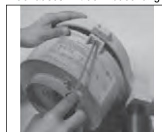
Bild 8 - Zusammenbau des Gehäuses mit der Abdeckung
