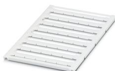
Repères pour blocs de jonction, Plaque, blanc, vierge, repérable avec : BLUEMARK ID COLOR, BLUEMARK ID, BLUEMARK CLED, PLOTMARK, CMS-P1-PLOTTER, type de montage: encliquetage, pour bloc de jonction au pas de : 12 mm, surface utile: 11,45 x 5,1 mm, Nombre d'étiquettes: 40
