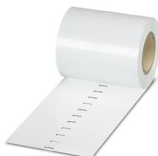
Repères pour blocs de jonction, Rouleau, blanc, vierge, repérable avec : THERMOMARK ROLL 2.0, THERMOMARK ROLL, THERMOMARK ROLL X1, THERMOMARK ROLLMASTER 300/600, THERMOMARK X1.2, THERMOMARK S1.1, perforé, type de montage: encliquetage, encliquetage dans la rainure de repérage plate, pour bloc de jonction au pas de : 10,2 mm, surface utile: 6,35 x 10,15 mm, Nombre d'étiquettes: 10000
