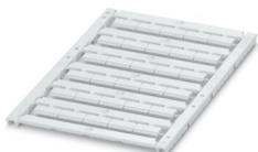
Repères pour blocs de jonction, Planche, blanc, vierge, repérable avec : TOPMARK NEO, LASER TOPMARK, BLUEMARK ID COLOR, BLUEMARK ID, BLUEMARK CLED, THERMOMARK PRIME, THERMOMARK CARD 2.0, THERMOMARK CARD, type de montage: encliquetage, pour bloc de jonction au pas de : 12 mm, surface utile: 11,2 x 4,7 mm, Nombre d'étiquettes: 30
