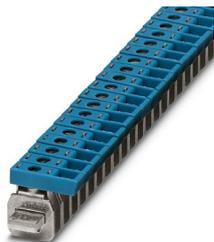
Bloc de jonction, tension nominale: 300 V, intensité nominale: 41 A, type de raccordement: Raccordement vissé, Section de référence: 4 mm<sup>2</sup>, section : 0,5 mm<sup>2</sup> - 6 mm<sup>2</sup>, montage: Barre collectrice de N, coloris: bleu
