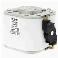
**Cartouche fusible, grande vitesse, 3000 A, AC 800 V, size 4, 146 x 105 x 90 mm, aR, IEC, indicateur de type K**
