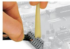
Raccordement des conducteurs, avec outil de manipulation
