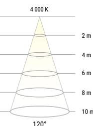
Luminance (lx) - Diamètre du cône (Ø cm) - Distance (m)
