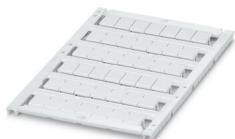
Repères pour blocs de jonction, Planche, blanc, vierge, repérable avec : TOPMARK NEO, LASER TOPMARK, BLUEMARK ID COLOR, BLUEMARK ID, BLUEMARK CLED, THERMOMARK PRIME, THERMOMARK CARD 2.0, THERMOMARK CARD, type de montage: encliquetage, pour bloc de jonction au pas de : 8,2 mm, surface utile: 7,6 x 10,5 mm, Nombre d'étiquettes: 42
