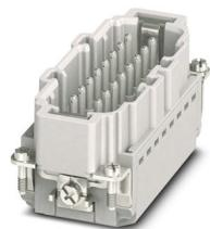
Élément de contact, nombre de pôles: 16+PE, taille: B16, nombre de raccordements par pôle: 1, Mâle, Raccordement Push-in, 500 V, 16 A, 0,14 mm<sup>2</sup> ... 2,5 mm<sup>2</sup>, application: Puissance
