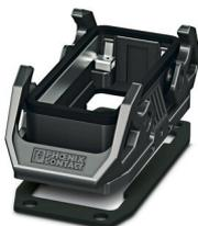
Embase HEAVYCONNEX EVO en plastique, B16, avec verrouillage transversal, hauteur 30,5 mm, avec joint plat
