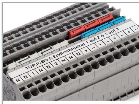
Le contact de pontage horizontal pour pontage continu, de 1 à 3, permet de ponter chaque deuxième borne dans un canal de pontage. Les potentiels plus et moins peuvent ainsi par ex. être distribués l'un à côté de l'autre.
