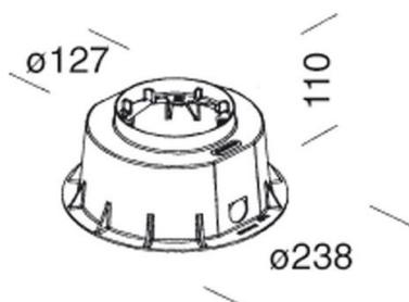
en nylon chargé en f.v. Utiliser pour encastrer Microfloor dans le terrain
