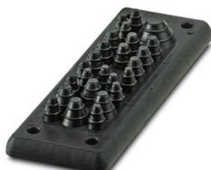
Plaques passe-câble, nombre de conducteurs: 25, diamètre extérieur du câble: 3x 3 mm ... 6 mm, 9x 3 mm ... 7 mm, 8x 6 mm ... 9 mm, 4x 6 mm ... 12 mm, 1x 10 mm ... 20 mm, matériau: PP (matériel intérieur), matériau: TPE-SEBS (matériel extérieur), coloris: noir, longueur: 154 mm, largeur: 56 mm, hauteur: 20 mm
