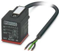
Câble pour capteurs/actionneurs, 3-pôles exempt d'halogène, extrémité libre, sur Connecteur de vanne A, avec 1 LED, câblé avec Diode zéner, longueur de câble: 3 m, pour applications extérieures, avec vis centrale en acier inoxydable et joint silicone supplémentaire (rouge)
