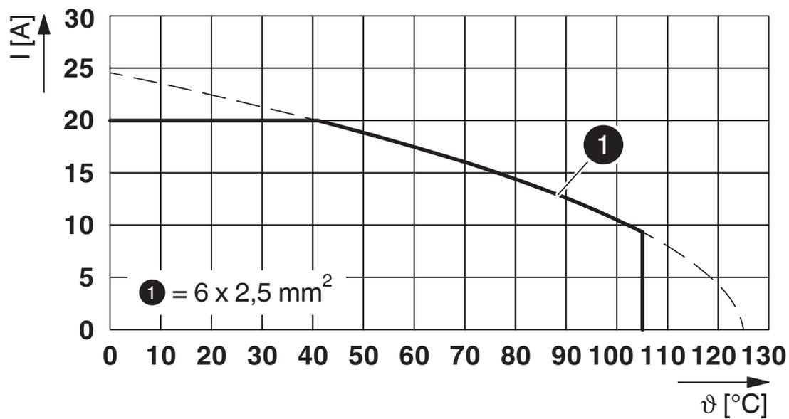
$I$  = intensité,  $\vartheta$  = température ambiante, 6x 20 A
