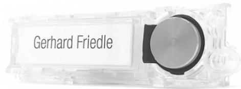
Bouton maître pouvant être utilisé dans les systèmes numériques 2 fils et ViP, composé d'un porte-étiquette et d'un bouton d'appel de pression en acier. La luminosité de la LED blanche est réglable sur le dos. L'installation est prévue sur des plaques métalliques de 2.5 mm d'épaisseur.
