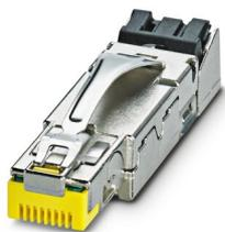
Connecteur RJ45, type: RJ45, indice de protection: IP20, nombre de pôles: 8, 10 Gbit/s, CAT6<sub>A</sub>, matériau: Métal, type de raccordement: Raccordement autodénudant, section raccordable: AWG 23- 22, sortie du câble: droit, coloris: jaune, Ethernet
