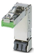
Connecteur RJ45, type: RJ45, indice de protection: IP20, nombre de pôles: 8, 1 Gbit/s, CAT5, matériau: Métal, type de raccordement: Raccordement autodénudant, section raccordable: AWG 23- 22, sortie du câble: coudé, Ethernet / PROFINET
