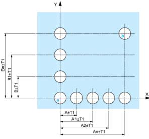
A: 30 mm min. / 1,18 pouce min. B: 40 mm min. / 1,57 pouce min.
