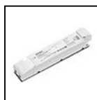
S.2401 ALIMENTATION ELECTRONIQUE NON GRADABLE 60W 230Vac/24Vdc IP20 Entrée: 230V Courant alterné Sortie: 24V Courant continu. Le nombre maximum d'appareils dépend de la somme des puissances unitaires de l'appareil. CLASSE II SELV Dimensions: 225 x 43 x 29,8 mm L'UTILISATION DU DÉCHARGEUR À SURTENSION S.2499 EST RECOMMANDÉE POUR CHAQUE BALLAST ÉLECTRONIQUE QUI DOIT ÊTRE INSTALLÉ À UNE DISTANCE MAXIMALE DE 10m DE CELUI-CI.
