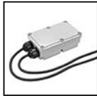
S.2496 DALI RELAY SWITCH pour ON-OFF (NON GRADABLES) 230V APPAREILS Tous les appareils fonctionnant à 230V non gradables (ON-OFF) peuvent être contrôlés ON-OFF avec le système DALI avec les accessoires interfaces suivants. Il s'en suit que l'appareil sera contrôlé à distance dans le seul mode ON-OFF et non pas en mode gradable. IP67 Max nominal load 1000VA Max switching current 8A Max inrush current 80A Dimensions 175,5mm x 86,5mm x 43mm
