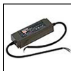
S.2406 ALIMENTATION ELECTRONIQUE NON GRADABLE 90W 230Vac/24Vdc IP67 Entrée: 230V Courant alternatif Sortie: 24V Courant continu. Le nombre maximum d'appareils dépend de la somme des puissances unitaires de l'appareil. CLASSE II SELV Dimensions: 171 x 63 x 37,5 mm L'UTILISATION DU DÉCHARGEUR À SURTENSION S.2499 EST RECOMMANDÉE POUR CHAQUE BALLAST ÉLECTRONIQUE QUI DOIT ÊTRE INSTALLÉ À UNE DISTANCE MAXIMALE DE 10m DE CELUI-CI.
