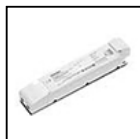
S.2401 ALIMENTATION ELECTRONIQUE NON GRADABLE 60W 230Vac/24Vdc IP20 Entrée: 230V Courant alternatif Sortie: 24V Courant continu. Le nombre maximum d'appareils dépend de la somme des puissances unitaires de l'appareil. CLASSE II SELV Dimensions: 225 x 43 x 29,8 mm L'UTILISATION DU DÉCHARGEUR À SURTENSION S.2499 EST RECOMMANDÉE POUR CHAQUE BALLAST ÉLECTRONIQUE QUI DOIT ÊTRE INSTALLÉ À UNE DISTANCE MAXIMALE DE 10m DE CELUI-CI.
