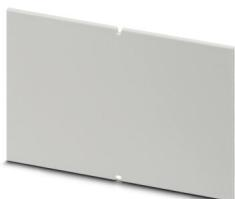
Paroi latérale à utiliser avec les demi-coques de boîtiers dans les dimensions 125 x 87 mm et 145 x 125 mm ; épaisseur de paroi : 2 mm ; hauteur totale du boîtier : 67 mm ; matériau : polycarbonate ; couleur gris clair similaire à RAL 7035
