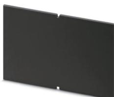
Paroi latérale à utiliser avec les demi-coques de boîtiers dans les dimensions 125 x 87 mm et 145 x 125 mm ; épaisseur de paroi : 2 mm ; hauteur totale du boîtier : 67 mm ; matériau : polycarbonate ; couleur noire similaire à RAL 9005
