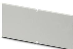
Paroi latérale à utiliser avec les demi-coques de boîtiers dans les dimensions 125 x 87 mm et 145 x 125 mm ; épaisseur de paroi : 2 mm ; hauteur totale du boîtier : 47 mm ; matériau : polycarbonate ; couleur gris clair similaire à RAL 7035
