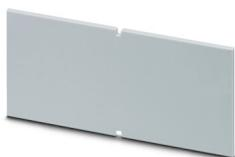
Paroi latérale à utiliser avec les demi-coques de boîtiers dans les dimensions 125 x 87 mm et 145 x 125 mm ; épaisseur de paroi : 2 mm ; hauteur totale du boîtier : 47 mm ; matériau : aluminium
