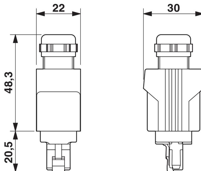
Connecteur mâle RJ45 Push-Pull, IP67
