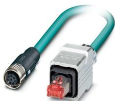
Câble de réseau, Ethernet CAT5 (1 Gbit/s), 8-pôles, Type de câble variable, blindé, Connecteur femelle droit M12, détrompage: A SPEEDCONNEC / IP67, sur connecteur mâle droit RJ45 Push-Pull / IP67, longueur de câble: Longueur au choix (0,2... 40,0 m)
