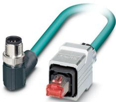
Câble de réseau, Ethernet CAT5 (1 Gbit/s), 8-pôles, Type de câble variable, blindé, connecteur mâle coudé M12, détrompage: A SPEEDCONNEC / IP67, sur connecteur mâle droit RJ45 Push-Pull / IP67, longueur de câble: Longueur au choix (0,2... 40,0 m)
