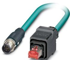
Câble de réseau, Ethernet CAT5 (1 Gbit/s), 8-pôles, Type de câble variable, blindé, connecteur mâle droit M12, détrompage: A SPEEDCONNEC / IP67, sur connecteur mâle droit RJ45 Push-Pull / IP67, longueur de câble: Longueur au choix (0,2... 40,0 m)
