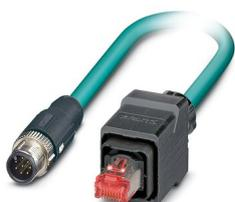
Câble de réseau, Ethernet CAT5 (1 Gbit/s), 8-pôles, blindé, connecteur mâle droit M12, détrompage: A SPEEDCONNEC / IP67, sur connecteur mâle droit RJ45 Push-Pull / IP67, longueur de câble: 1 m
