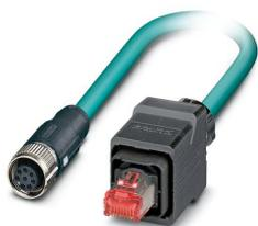
Câble de réseau, Ethernet CAT5 (1 Gbit/s), 8-pôles, Type de câble variable, blindé, Connecteur femelle droit M12, détrompage: A SPEEDCONNEX / IP67, sur connecteur mâle droit RJ45 Push-Pull / IP67, longueur de câble: Longueur au choix (0,2... 40,0 m)
