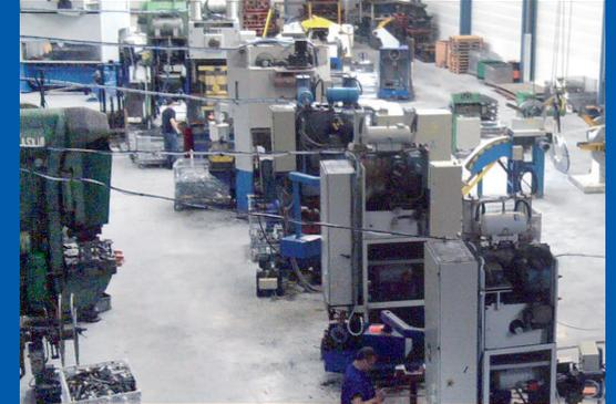
Presses mécaniques de découpe et emboutissage tôlerie
