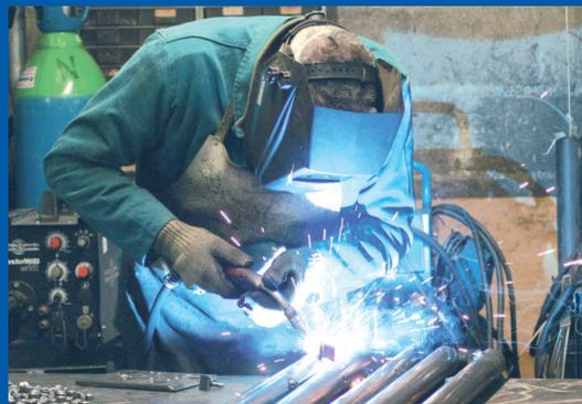
Soudure électrique des fixations
