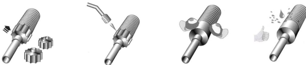
Insérer la manchette sur le tube caloporteur et l'enveloppe extérieure de protection, chauffer la manchette au chalumeau pour la rétracter (pas de flamme bleue), bien plaquer la manchette en portant des gants de protection, l'extrémité du tube est étanche.
