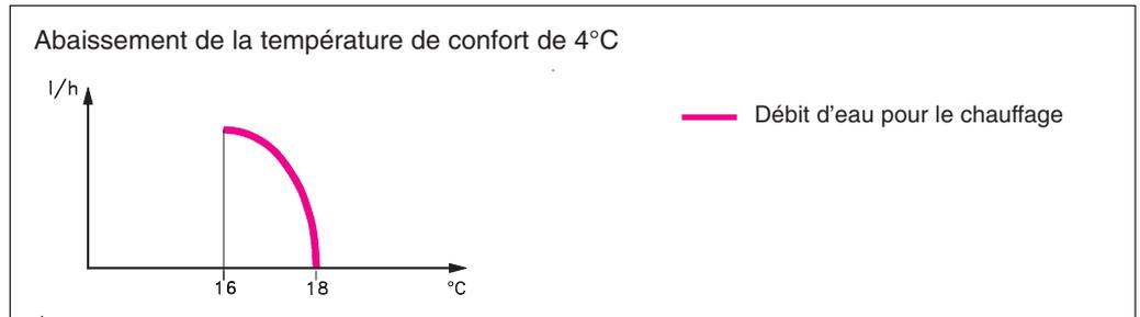
Le régulateur est positionné dans la partie bleue, à 4 °C en-dessous de la température de confort qui est fixée à 22 °C (repère du milieu). Etant donné que  $Xp = 0 K$ , la vanne du circuit de refroidissement ne s'ouvrira que lorsque la température descendra en-dessous de 18° C : (22°C - 4 K).
