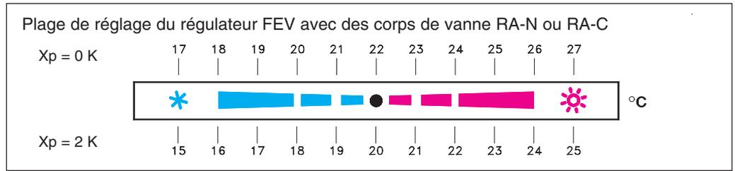
Quand le repère est positionné sur la partie centrale des graduations, cela signifie que la vanne ne s'ouvrira que si la température désirée descend en dessous de 22°C. Un réglage dans la partie rouge signifie que l'ouverture de vanne se fera à une température ambiante plus élevée. Un réglage dans la partie bleue signifie que l'on souhaite conserver une température ambiante inférieure à 22 °C.
