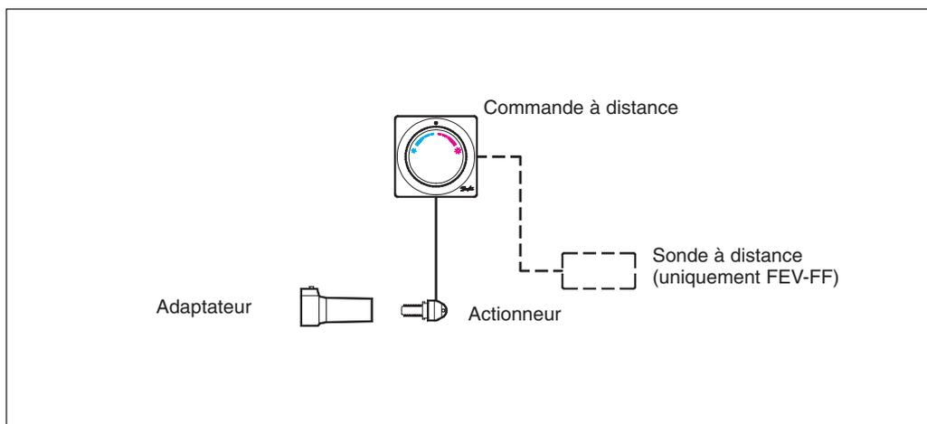
Le régulateur FEV peut-être combiné avec des corps RA-N ou RA-C. Le régulateur FEV est équipé d'un système d'action directe qui ouvre la vanne dès que la température de-
