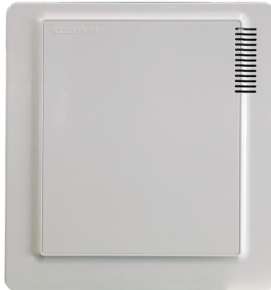
Boîtier mural en ABS ininflammable pour cartes centrale série VEDO art. PCBVEDO10FR, PCBVEDO34FR et PCBVEDO68FR. Blanc RAL 9003. Peut accueillir la batterie 7 A/h, l'alimentation art. PSU15 et jusqu'à 2 cartes d'extension sur bus. Dimensions (L x H x P) 260 x 280 x 80 mm. EN50131 Grade 2.
