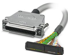
Câble rond pré-équipé; automate: Siemens SIMATIC® ET 200SP HA; raccordement 1 : Connecteur femelle D-SUB (1x 37-pôles); raccordement 2 : IDC/FLK connecteur femelle (1x 50-pôles); longueur de câble: 10 m
