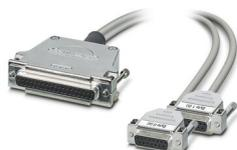
Câble rond pré-équipé; automate: Siemens SIMATIC® ET 200SP HA; raccordement 1 : Connecteur femelle D-SUB (1x 37-pôles); raccordement 2 : Connecteur femelle D-SUB (2x 15-pôles); longueur de câble: variable
