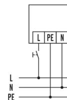
Raccordement standard avec interrupteur
