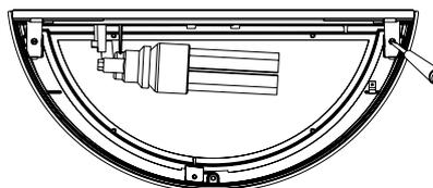
4. Fixer l'ensemble bloc optique sur l'embase en vissant les 2 vis
