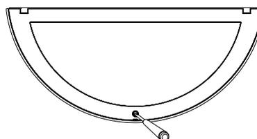
8. Fixer l'ensemble capot sur l'ensemble corps en vissant la vis
