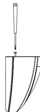
7. Fixer l'ensemble bloc optique sur l'embase en vissant les 2 vis
