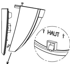
5. Positionner l'ensemble bloc Optique sur l'embase
