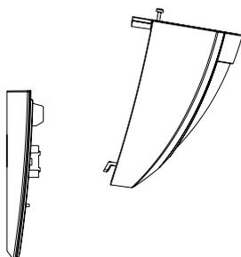
3. Prendre l'ensemble bloc optique avec les 2 vis desserrées
