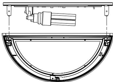
3. Positionner l'ensemble bloc optique sur l'embase
