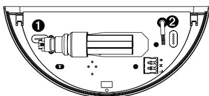
1. Fixer l'embase au mur en utilisant les points de fixation ① & ②
