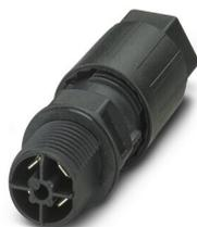
Traversée de paroi, Raccordement QUICKON, nombre de pôles: 3+PE, 690 V, 20 A, noir, avec écrou QUICKON, diamètre extérieur du câble: 6 mm ... 10 mm, filetage de montage: M25, Raccordement IDC, 2,5 mm<sup>2</sup>
