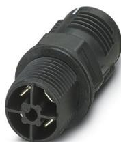
Traversée de paroi, Raccordement QUICKON, nombre de pôles: 3+PE, 690 V, 20 A, noir, sans écrou QUICKON, filetage de montage: M25, Raccordement par clips, 2,5 mm<sup>2</sup>
