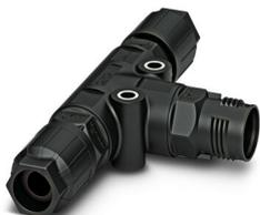
Répartiteur en T, Raccordement QUICKON, nombre de pôles: 3+PE, 690 V, 20 A, noir, avec deux écrous QUICKON, diamètre extérieur du câble: 6 mm ... 10 mm
