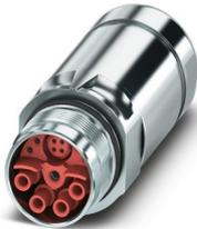
M23, Connecteur prolongateur, série: SH, droit, long, blindé: oui, Pour verrouillage standard et SPEEDCON, Nombre de pôles: 4+4+PE / 3+N+PE, Sens de rotation: standard, type de contact: Mâle, Raccordement à sertir, plage de diamètre de câble: 12 mm ... 15 mm, détrompage: N, L'article est sans plomb, conformément à la directive RoHS II, sans exception 6c (Pb < 0,1 %)
