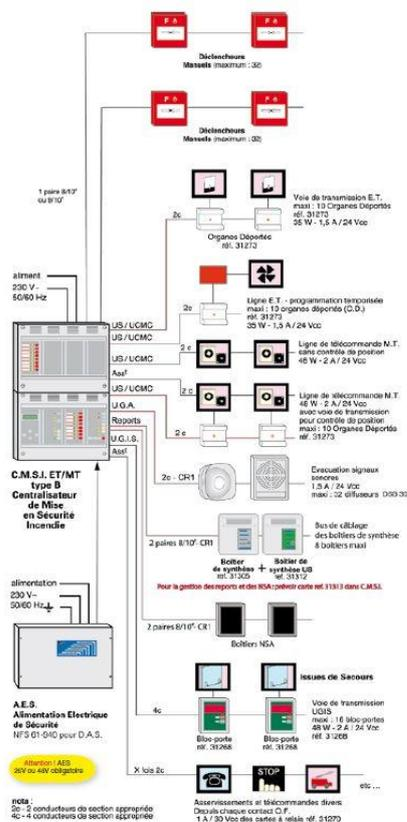
Équipé de 8 boucles de détection, d'une Unité de Gestion d'Alarme (UGA), de 8 commandes de mise en sécurité et de 4 voies de transmission.
