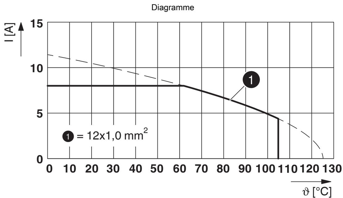
$I$  = intensité,  $\vartheta$  = température ambiante, 12x 8 A
