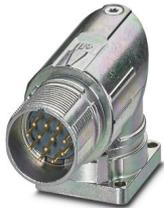
M23, Embases paroi avant, série: M23 PRO, coudé rotatif, Pour verrouillages rapides standard et ONECLICK, Nombre de pôles: 12, Sens de rotation: standard, type de contact: Mâle, Raccordement à sertir, cote de bride: 28 mm x 28 mm, détrompage: N, L'article est sans plomb, conformément à la directive RoHS II, sans exception 6c (Pb < 0,1 %)
