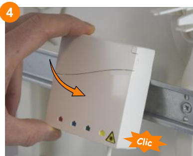
4 Clipper le DTlo sur le rail DIN dans le coffret. Le DTlo peut également se clipper avec les sorties orientées sur le côté.
