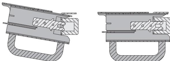
La forme en C qui distingue la partie finale de la poignée permet le centrage du dispositif en cas de désaxement entre la protection et le châssis. Un alignement optimal est ainsi obtenu entre l'actionneur et l'interrupteur, en préservant le produit des dommages qui seraient dus à des collisions.
