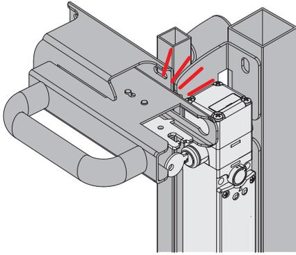
La structure de la poignée et de l'étrier de fixation de l'interrupteur permet de placer l'actionneur et l'interrupteur à l'abri des chocs possibles qui pourraient entraîner des dommages. Les éventuels chocs dus à un actionnement erroné sont déchargés entièrement sur la structure de la poignée.
