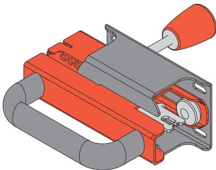
Levier en option pour l'ouverture d'urgence de l'intérieur : il permet toujours la sortie du personnel qui serait accidentellement bloqué dans la zone dangereuse. À associer aux interrupteurs sans blocage (ex. FD •93-M2) ou avec bouton de déverrouillage antipanique (ex. FG •••D6D••).
