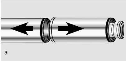
a - Sur le conduit coulissant, séparer les 2 conduits métalliques.
