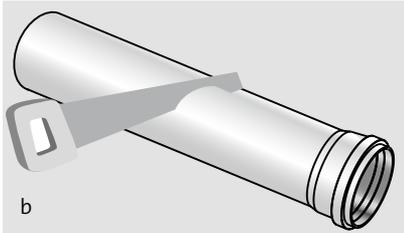
b - Recouper le conduit intérieur en PPTI si nécessaire.
