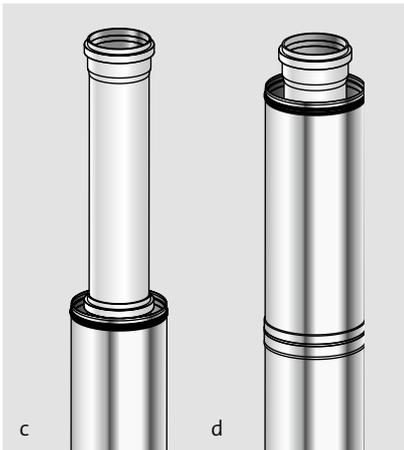
c - Monter le conduit PPTI dans le conduit bas déjà installé.
