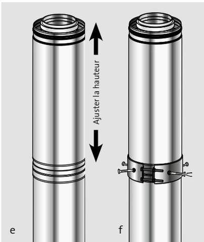
e - Installer la 2<sup>e</sup> partie du conduit métallique (partie femelle)
