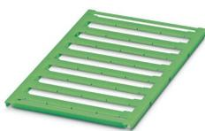
Repères pour blocs de jonction, Plaque, vert, vierge, repérable avec : BLUEMARK ID COLOR, BLUEMARK ID, BLUEMARK CLED, PLOTMARK, CMS-P1-PLOTTER, type de montage: encliquetage, pour bloc de jonction au pas de : 16 mm, surface utile: 15,45 x 5,1 mm, Nombre d'étiquettes: 32
