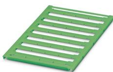
Repères pour blocs de jonction, à commander : sous forme de planche, vert, impression selon les indications du client, type de montage: encliquetage dans la rainure de repérage plate, pour bloc de jonction au pas de : 16 mm, surface utile: 15,45 x 5,1 mm, Nombre d'étiquettes: 32
