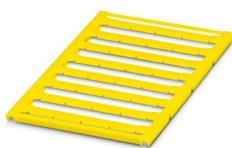
Repères pour blocs de jonction, à commander : sous forme de plaque, jaune, impression selon les indications du client, type de montage: encliquetage dans la rainure de repérage plate, pour bloc de jonction au pas de : 16 mm, surface utile: 15,45 x 5,1 mm, Nombre d'étiquettes: 32
