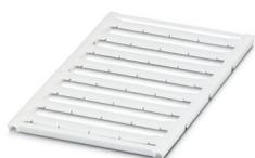
Repères pour blocs de jonction, Plaque, blanc, vierge, repérable avec : BLUEMARK ID COLOR, BLUEMARK ID, BLUEMARK CLED, PLOTMARK, CMS-P1-PLOTTER, type de montage: encliquetage, pour bloc de jonction au pas de : 16 mm, surface utile: 15,45 x 5,1 mm, Nombre d'étiquettes: 32
