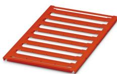
Repères pour blocs de jonction, à commander : sous forme de planche, rouge, impression selon les indications du client, type de montage: encliquetage dans la rainure de repérage plate, pour bloc de jonction au pas de : 16 mm, surface utile: 15,45 x 5,1 mm, Nombre d'étiquettes: 32
