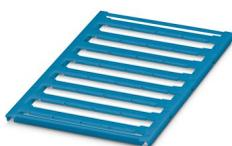
Repères pour blocs de jonction, à commander : sous forme de planche, bleu, impression selon les indications du client, type de montage: encliquetage dans la rainure de repérage plate, pour bloc de jonction au pas de : 16 mm, surface utile: 15,45 x 5,1 mm, Nombre d'étiquettes: 32
