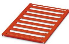
Repères pour blocs de jonction, Planche, rouge, vierge, repérable avec : BLUEMARK ID COLOR, BLUEMARK ID, BLUEMARK CLED, PLOTMARK, CMS-P1-PLOTTER, type de montage: encliquetage, pour bloc de jonction au pas de : 16 mm, surface utile: 15,45 x 5,1 mm, Nombre d'étiquettes: 32
