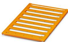
Repères pour blocs de jonction, Planche, orange, vierge, repérable avec : BLUEMARK ID COLOR, BLUEMARK ID, BLUEMARK CLED, PLOTMARK, CMS-P1-PLOTTER, type de montage: encliquetage, pour bloc de jonction au pas de : 16 mm, surface utile: 15,45 x 5,1 mm, Nombre d'étiquettes: 32
