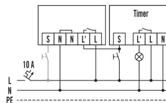
Raccordement avec commande optionnelle par poussoir. Mise en parallèle de 10 appareils au maximum.
