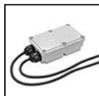
S.2496 DALI RELAY SWITCH pour ON-OFF (NON GRADABLES) 230V APPAREILS Tous les appareils fonctionnant à 230V non gradables (ON-OFF) peuvent être contrôlés ON-OFF avec le système DALI avec les accssoires interfaces suivants. Il s'en suit que l'appareil sera contrôlé à distance dans le seul mode ON-OFF et non pas en mode gradable. IP67 Max nominal load 1000VA Max switching current 8A Max inrush current 80A Dimensions 175,5mm x 86,5mm x 43mm
