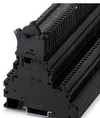
Bloc de jonction-fusibles, type de fusible: Verre / Céramique / ..., type de fusible: G / 5 x 20, tension nominale: 60 V, intensité nominale: 30 A, type de raccordement: Raccordement vissé, Section de référence: 4 mm<sup>2</sup>, section : 0,14 mm<sup>2</sup>- 6 mm<sup>2</sup>, type de raccordement: Raccordement vissé, Section de référence: 1 mm<sup>2</sup>, section : 0,14 mm<sup>2</sup>- 4 mm<sup>2</sup>, type de montage: NS 35/7,5, NS 35/15, coloris: noir
