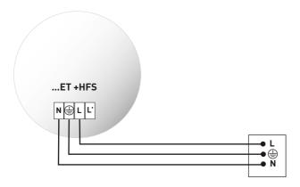
Um weitere Leuchten über die Sensorleuchte schalten zu können, ist über den Schaltausgang (L') ein Leistungsschütz nach zu schalten.
