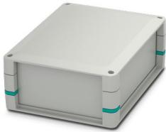
Boîtier complet pour circuit imprimé, fixé au niveau des inserts des montants d'angle, inclut des demi-coques de boîtier, des parois fermées, des inserts de montants d'angle avec support de fixation pour circuit imprimé, des vis pour boîtier et fixation du circuit imprimé, boîtier de couleur gris clair avec inserts de montants d'angle bleu turquoise
