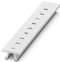
Repères pour blocs de jonction, Rubans, blanc, repéré, impression longitudinale: numérotation continue 1 ... 9, type de montage: encliquetage, pour bloc de jonction au pas de : 6,2 mm, surface utile: 10,5 x 6,15 mm, Nombre d'étiquettes: 9
