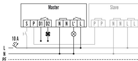
Raccordement maître/esclave avec commande optionnelle par poussoir. Un appareil maître peut être raccordé à 10 appareils esclaves au maximum.
